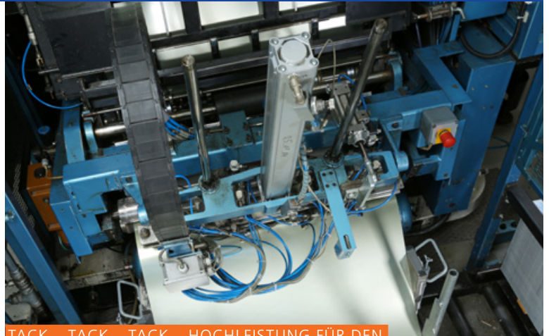
TACK – TACK – TACK – HOCHLEISTUNG FÜR DEN SCHMIERSTOFF | Schrittschaltgetriebe führen die bedruckten Tafeln dem kombinierten Stanz- und Tiefziehprozess zu.
