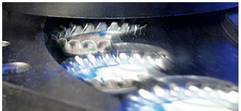
Den hat jeder schon einmal aus dem Kronkorken herausgepuhlt: DER WARMEINGEFORMTE KUNSTSTOFFEINLEGER SORGT FÜR DIE DICHTIGKEIT.
